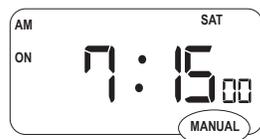
**Manual OFF:** Equipo apagado permanentemente.
