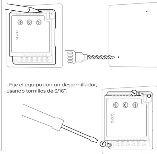
· Fije el equipo con un destornillador, usando tornillos de 3/16".
