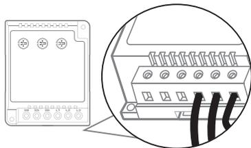
**3** Conecte los cables de la bobina del contactor
