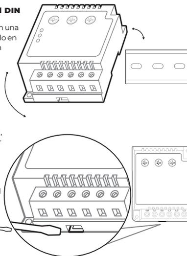
· Para retirarlo del riel, con un destornillador plano hale hacia abajo el gancho de retención que está ubicado en el dorso del GST-RM y retire el producto del riel.
